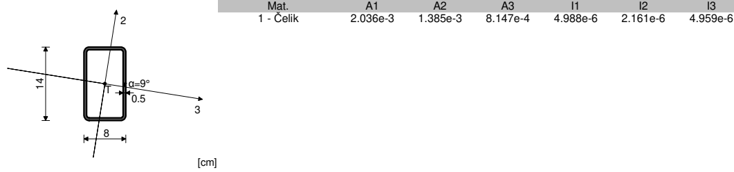
Set: 3 Presjek: HOP □ 140x80x5, Fiktivna ekscentričnost
